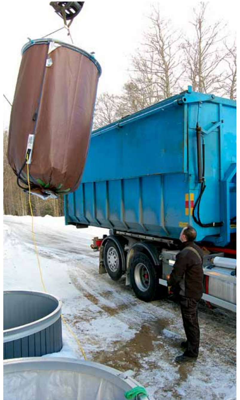
Underjordsbehållare är den bästa lösningen i fritidshusområden. De är hygieniska och rymmer hela fem kubikmeter och behöver inte tömmas lika ofta som kärn.
