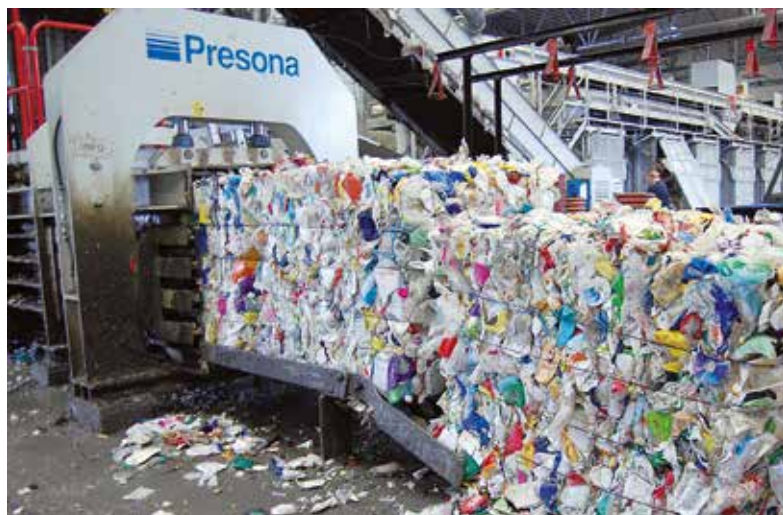
Återvinningsplasten sorteras i balar efter kvalitet innan den mals ner till plastflingor.
